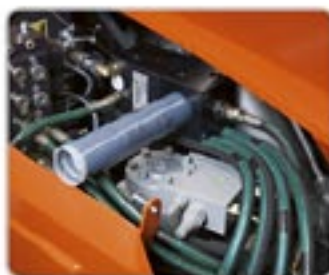
Bomba de grasa y lubricación automática estándar en las herramientas.
