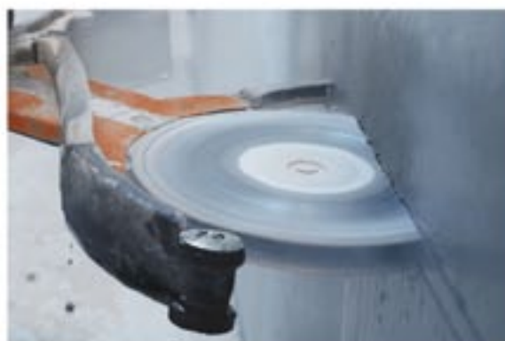
Discos gemelos. Discos gemelos especialmente desarrollados con alta velocidad de corte y gran potencia.
