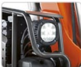
Potencia extra, focos LED resistentes a las vibraciones.
