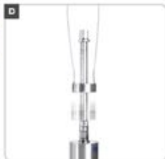
El extractor de corona facilita sacar la corona del agujero.
