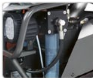
Bomba de grasa y lubricación automática estándar en las herramientas.
