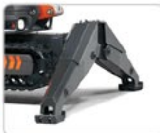
Patas con extensión adicional para mayor estabilidad y alta carga de trabajo.
